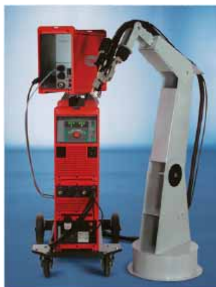
MagicWave 5000とRobacta KD-Driveコールドワイヤ送給装置搭載Robacta TTW 4500ロボット溶接トーチ
