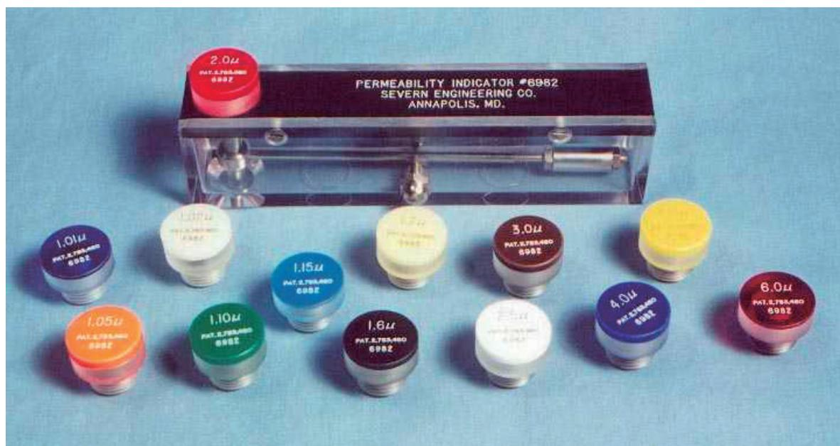
本器は、研究室、工場、現地で使用されるよう開発された、操作の簡単な上、丈夫な非破壊検査器です。オーステナイト系ステンレスとマンガン鋼の溶着金属、母材の合格テスト（受入れ）テストが即座に得られる go-no go（各範囲に入るか、はみ出るか）方式です。本器は外回りに何ら標準を要さず、調節、目盛表示も必要でなく、測定位置により左右されない。薄板、厚板、棒、不規則形状の物、又複雑な部品でも等しく充分検査できます。均質でない製品（被測物）中の透磁率の局所的な高低を効果的に探し出す。また冷間成形や焼鈍処理を必要とする現場でも利用できます。
