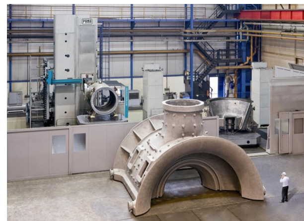
スチームタービン本体と部品 SIEMENS社（ドイツ）PAMA SPEEDRAM 2000
