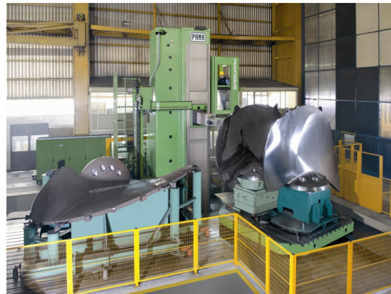
水車翼 IMPSA社（アルゼンチン） PAMA SPEEDRAM 3000
